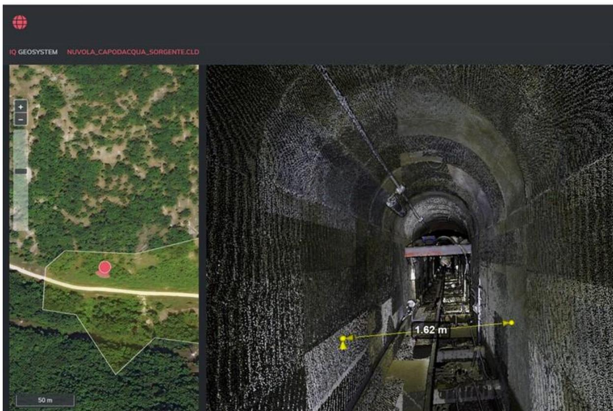
Di seguito vista-rilievo nuvola di punti sorgente Pescara- Proiezione sotto terra dello sviluppo delle Gallerie.
