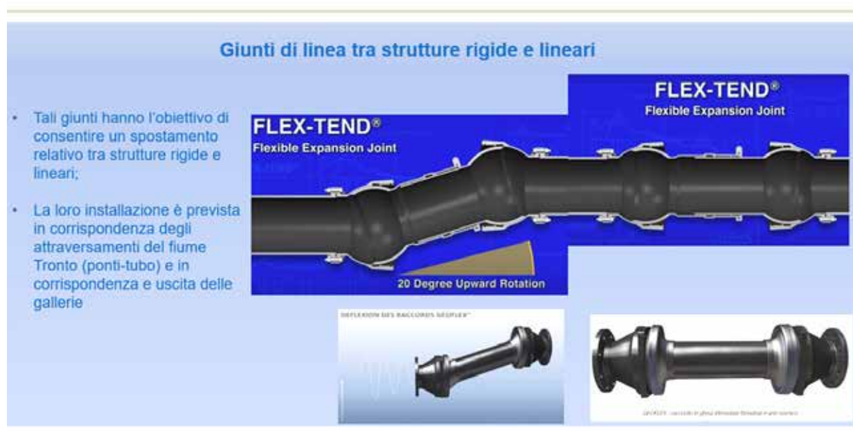
Soluzioni tecniche particolari adottate - Giunti di linea
